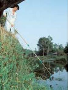
Campionatore a immersione - per il campionamento di acque da fiumi, laghi, cisterne, etc. - manico telescopico in alluminio estendibile da 1950 a 4700 mm - snodo terminale angolabile fino a 270 ° e molla di ritenuta per flacone di raccolta - peso 1500 g.
